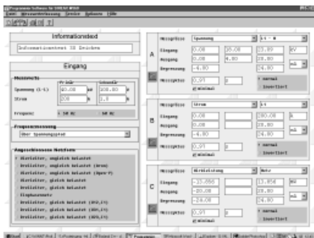
Bild 5. Darstellung aller Programmierparameter im Hauptmenü.
